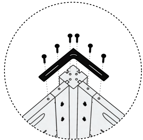
L 字プレートとネジの付け方
